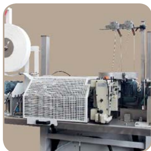
La máquina de cierre bolsa está disponible con los cabezales de costura de diferentes fabricantes
