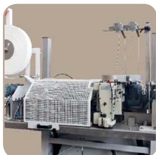
Машина для зашивания пакетов оснащена сшивающими головками другого производителя
